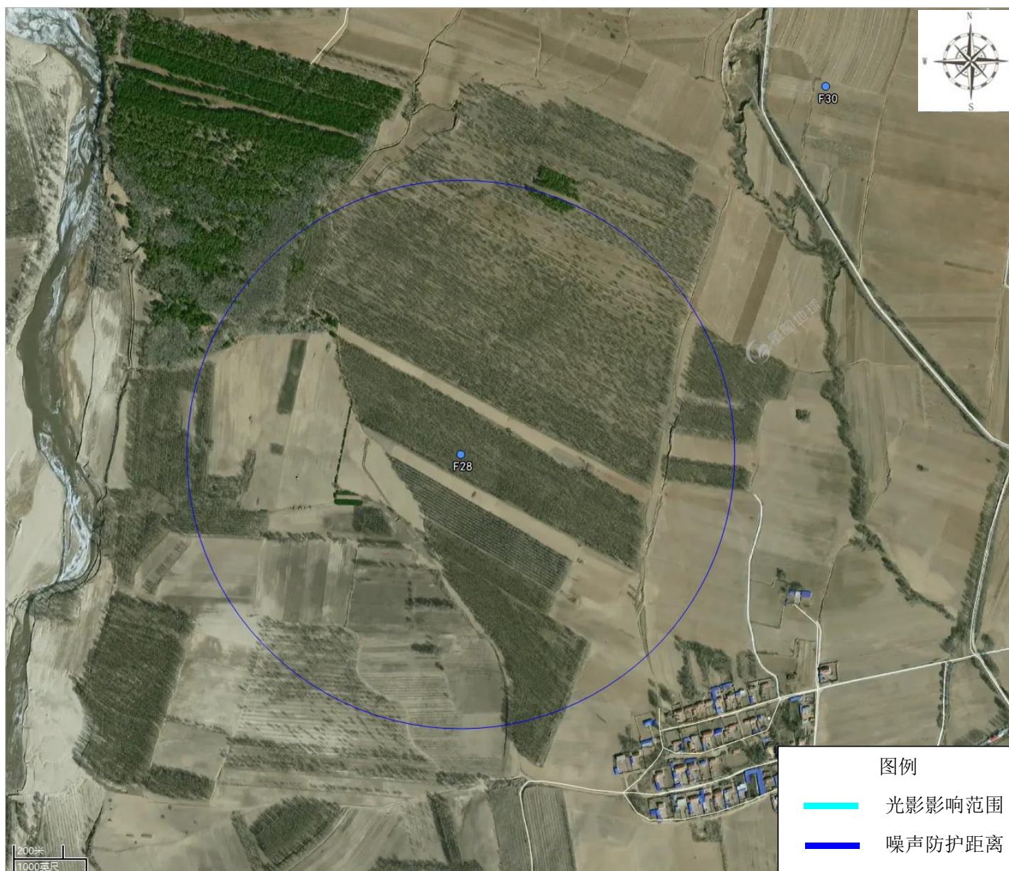
附图 18-19 本项目 F28 风机防护距离图
