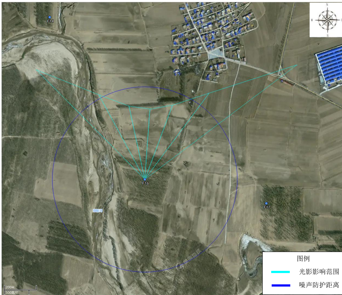
附图 18-9 本项目 F16 风机防护距离图
