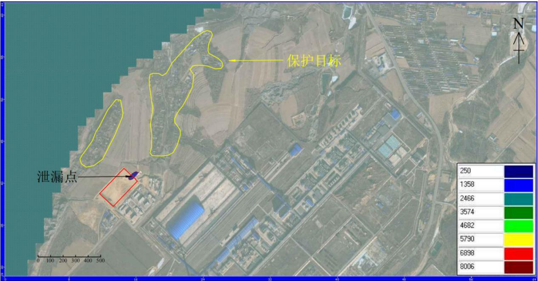
图5.2.3-91 渗漏5天污染影响范围（氯化物）
