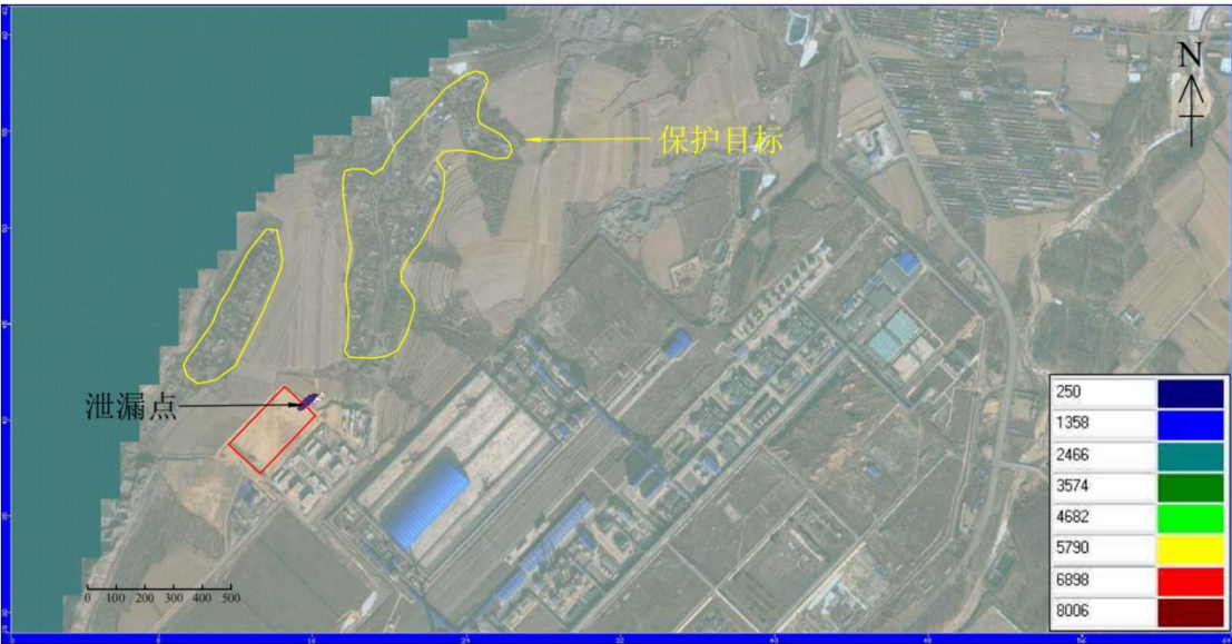
图5.2.3-92 渗漏10天污染影响范围（氯化物）
