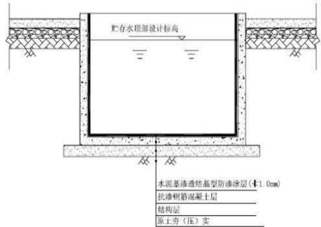
图6.2-7 污水处理池防渗示意图
