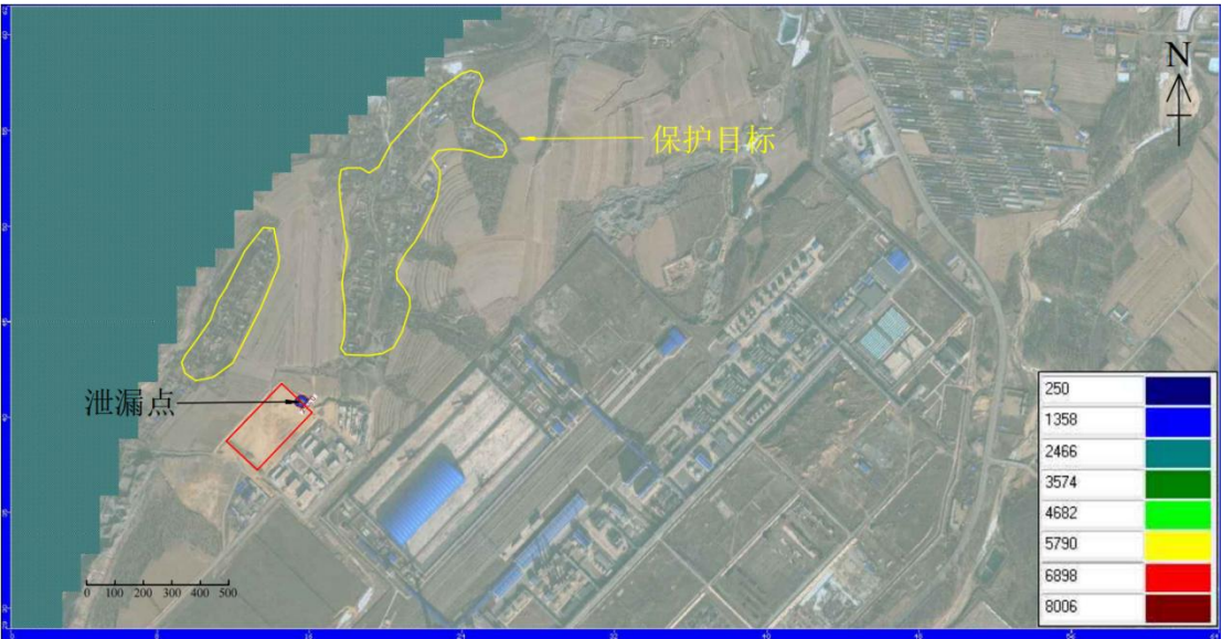
图5.2.3-90 渗漏1天污染影响范围（氯化物）
