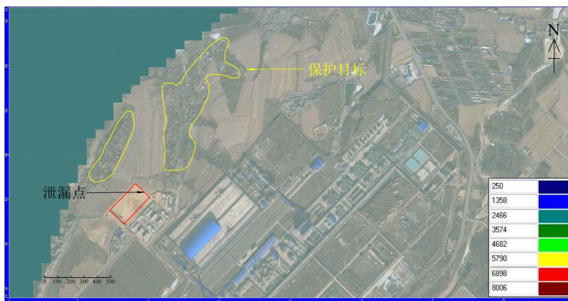
图5.2.3-96 渗漏1000天污染影响范围（氯化物）
