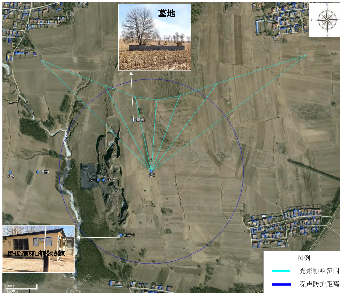
附图 18-18 本项目 F27 风机防护距离图
