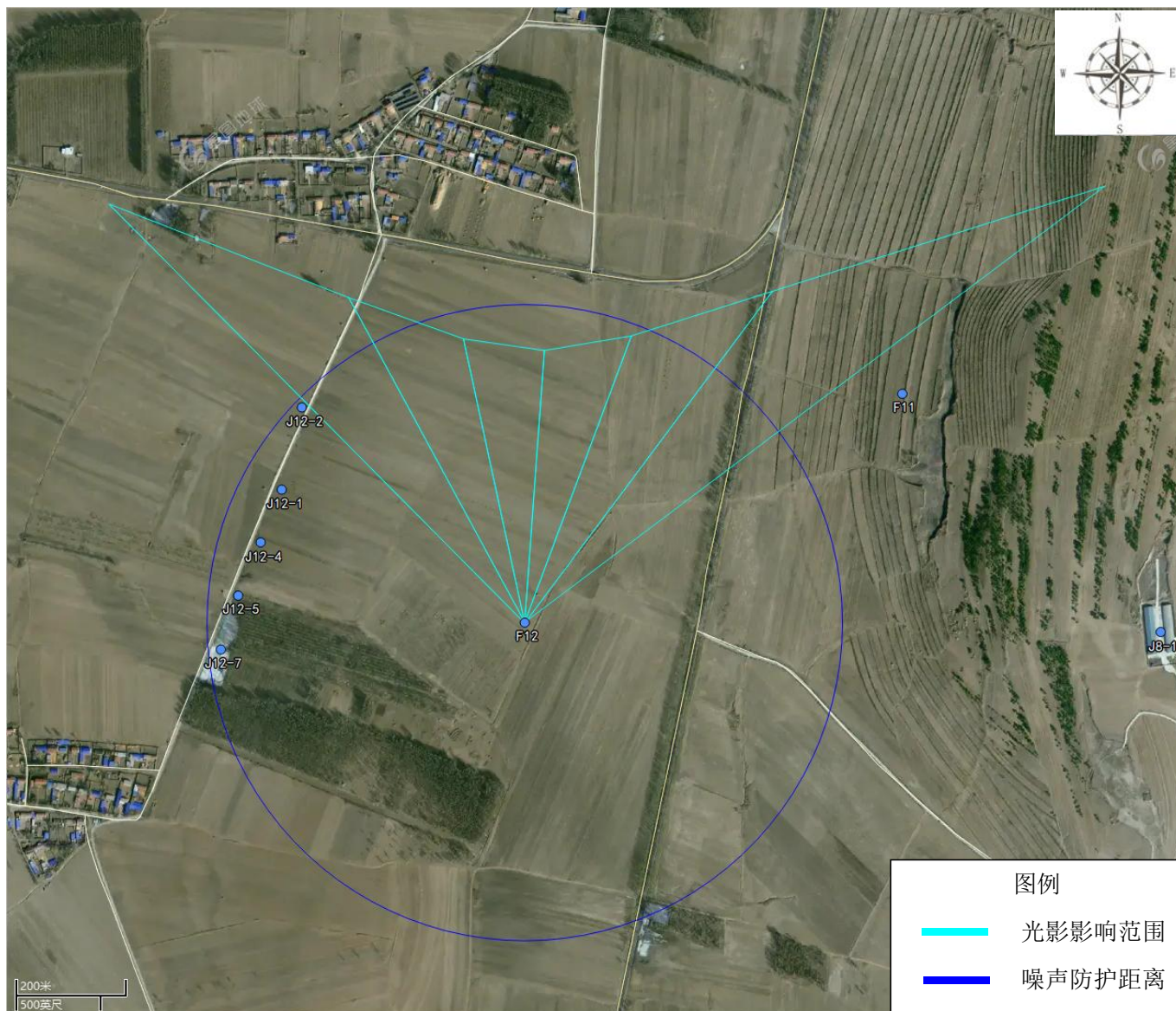
附图 18-6 本项目 F12 风机防护距离图
