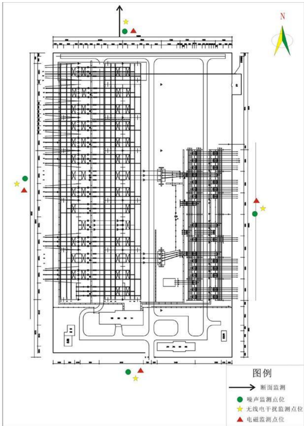
图 3-1 阜新东方 220 千伏变电站增容改造工程平面布置意图
