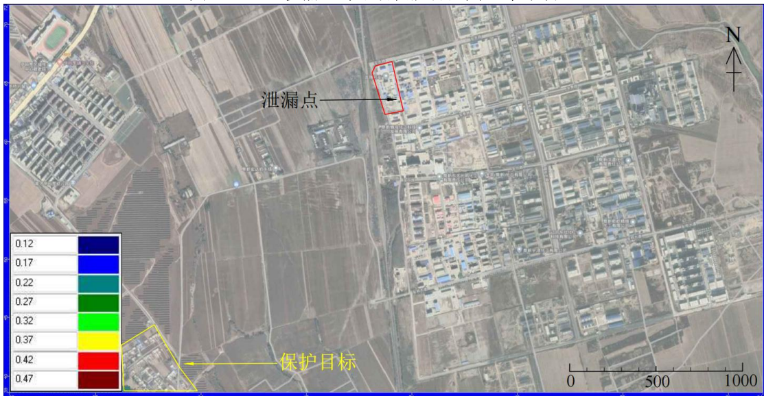
图 6.3-20 渗漏 40 天污染影响范围（苯系物）
