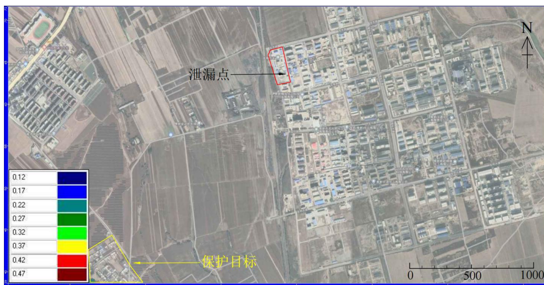
图 6.3-22 渗漏 1000 天污染影响范围（苯系物）
