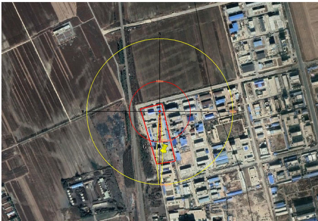
图 8.5-1 氯化氢泄漏扩散超过阈值的最大轮廓图（最常见气象条件）
