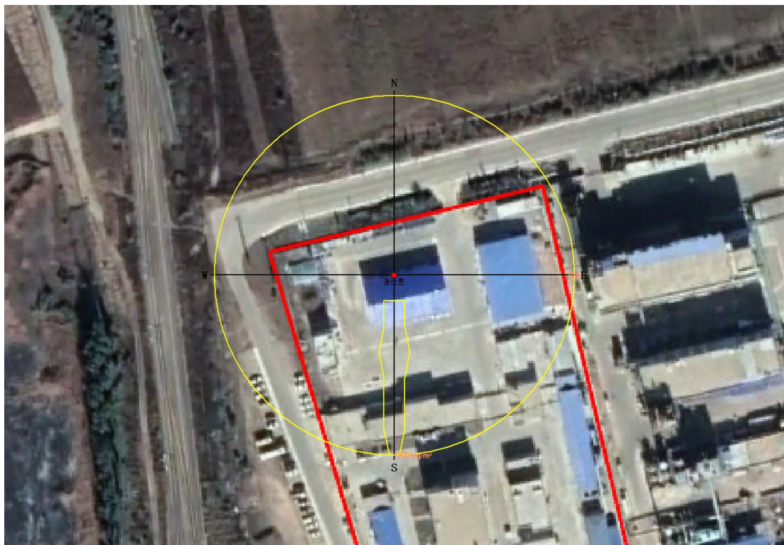
图 8.5-1 二氯甲烷泄漏扩散超过阈值的最大轮廓图（最常见气象条件）
