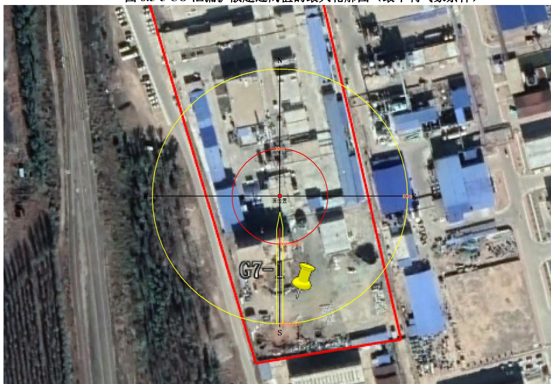
图 8.5-6 CO 泄漏扩散超过阈值的最大轮廓图（最常见气象条件）
