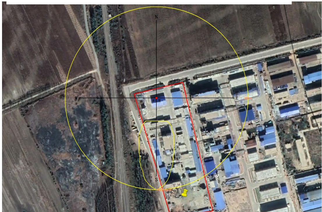
图 8.5-2 二氯甲烷泄漏扩散超过阈值的最大轮廓图（最不利气象条件）
