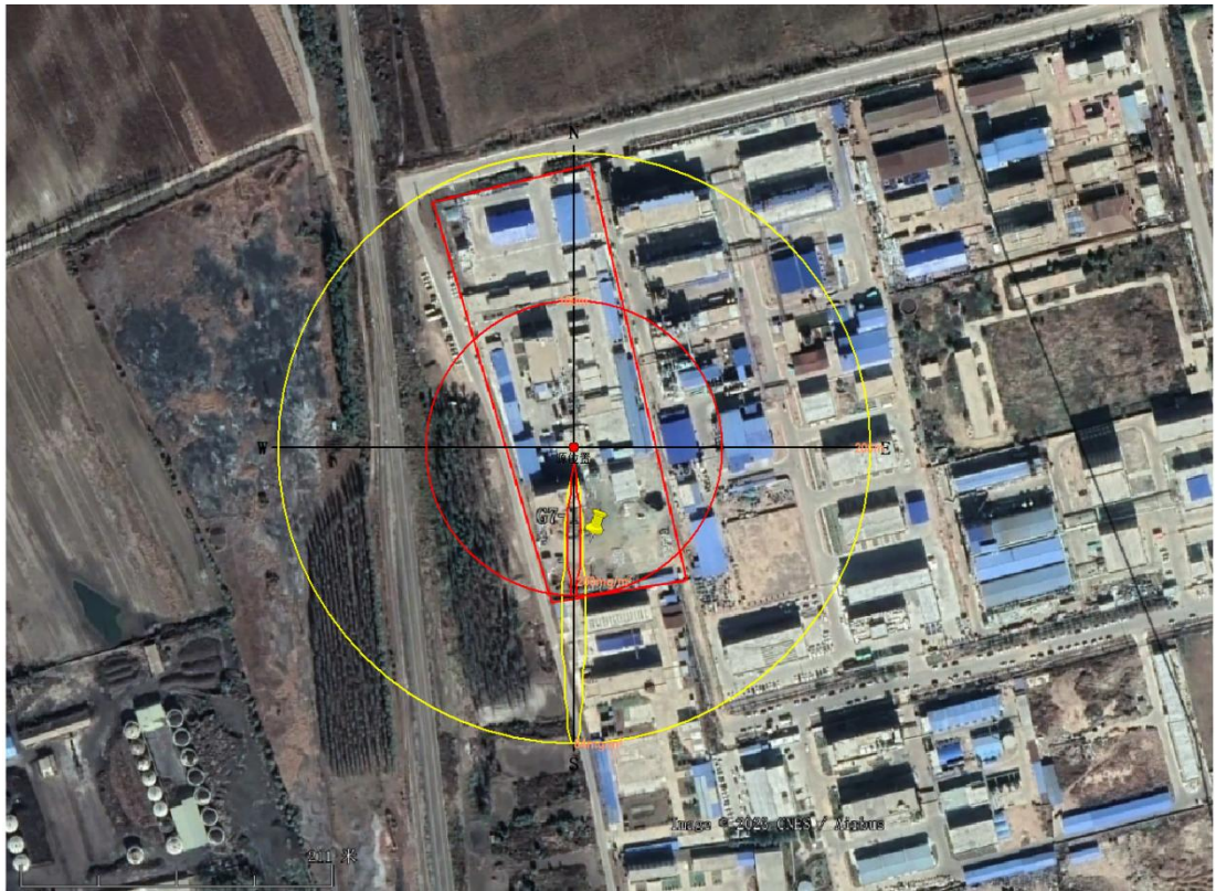
图 8.5-4 乙腈泄漏扩散超过阈值的最大轮廓图（最常见气象条件）
