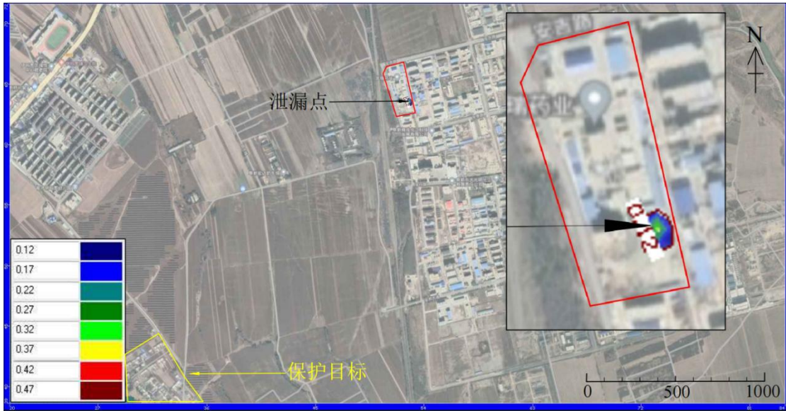
图 6.3-15 渗漏 10 天污染影响范围（苯系物）
