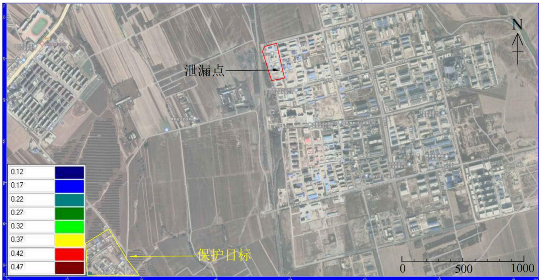
图 6.3-21 渗漏 100 天污染影响范围（苯系物）
