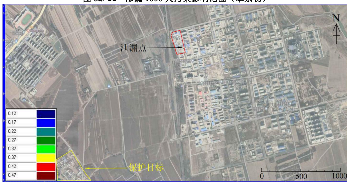
图 6.3-23 渗漏 3650 天污染影响范围（苯系物）
