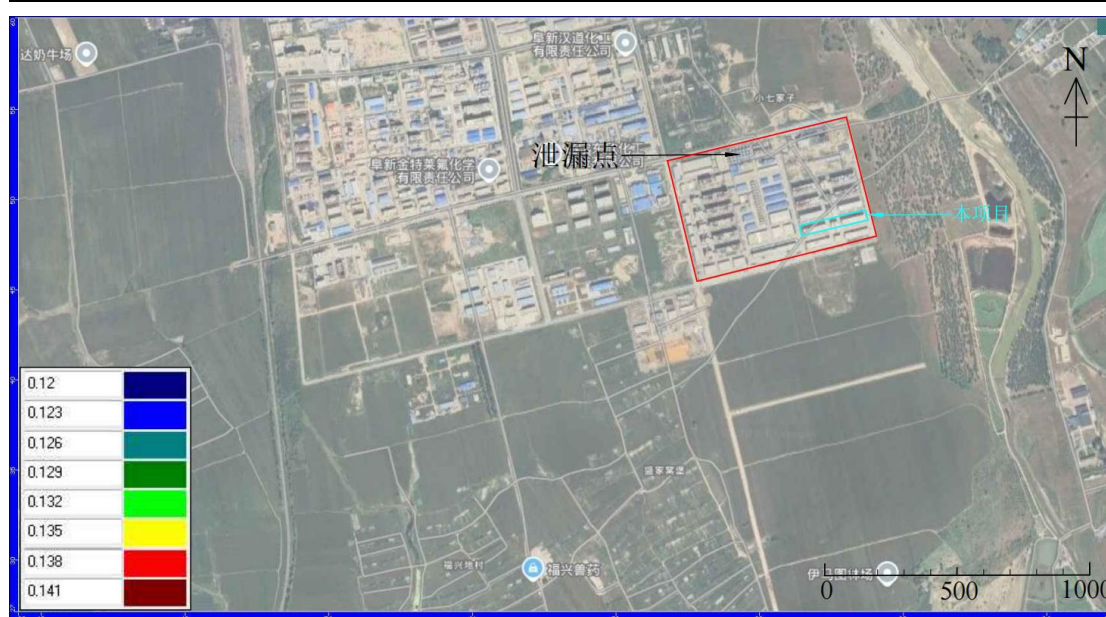
图 6.3-22 渗漏 3650 天污染影响范围（苯系物）
