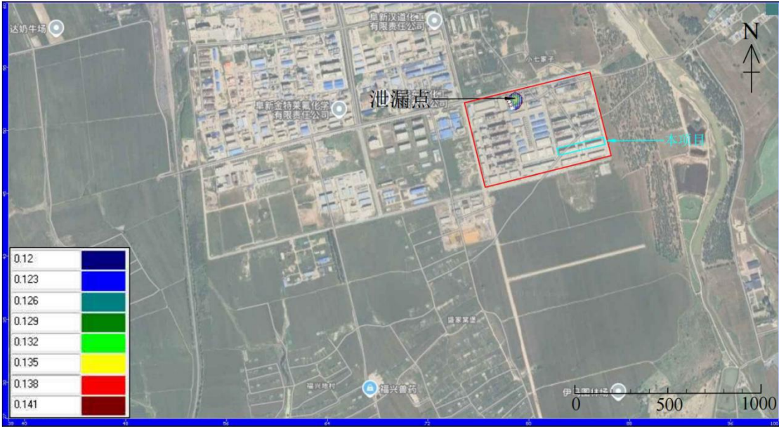
图 6.3-15 渗漏 30 天污染影响范围（苯系物）
