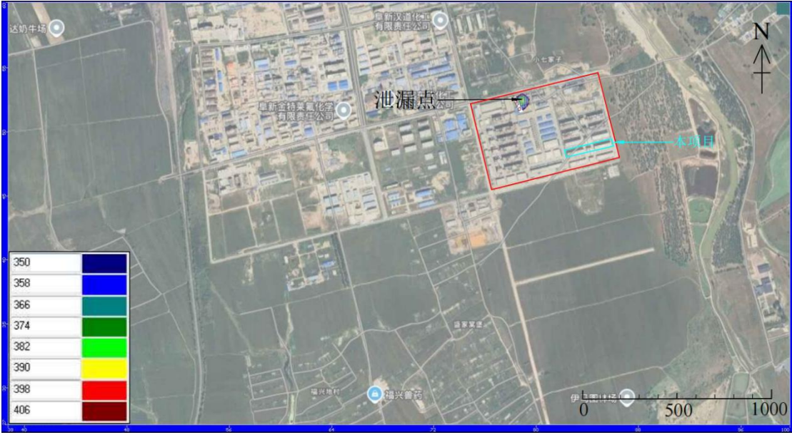
图 6.3-35 渗漏 30 天污染影响范围（氯化物）
