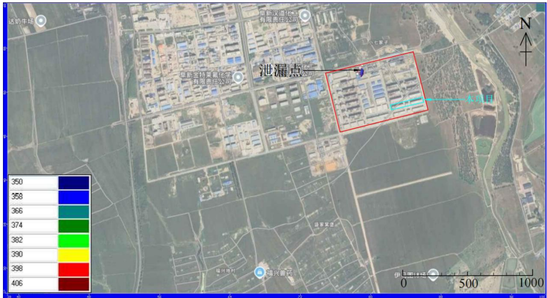
图 6.3-37 渗漏 38 天污染影响范围（氯化物）
