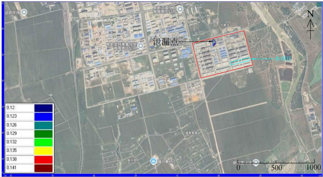
图 6.3-16 渗漏 35 天污染影响范围（苯系物）
