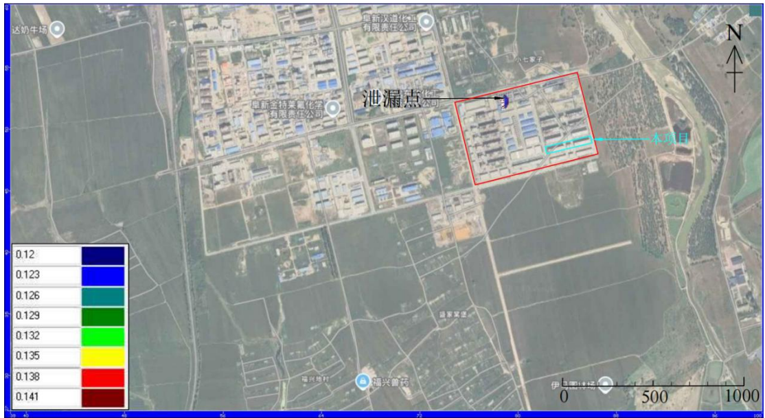
图 6.3-17 渗漏 41 天污染影响范围（苯系物）
