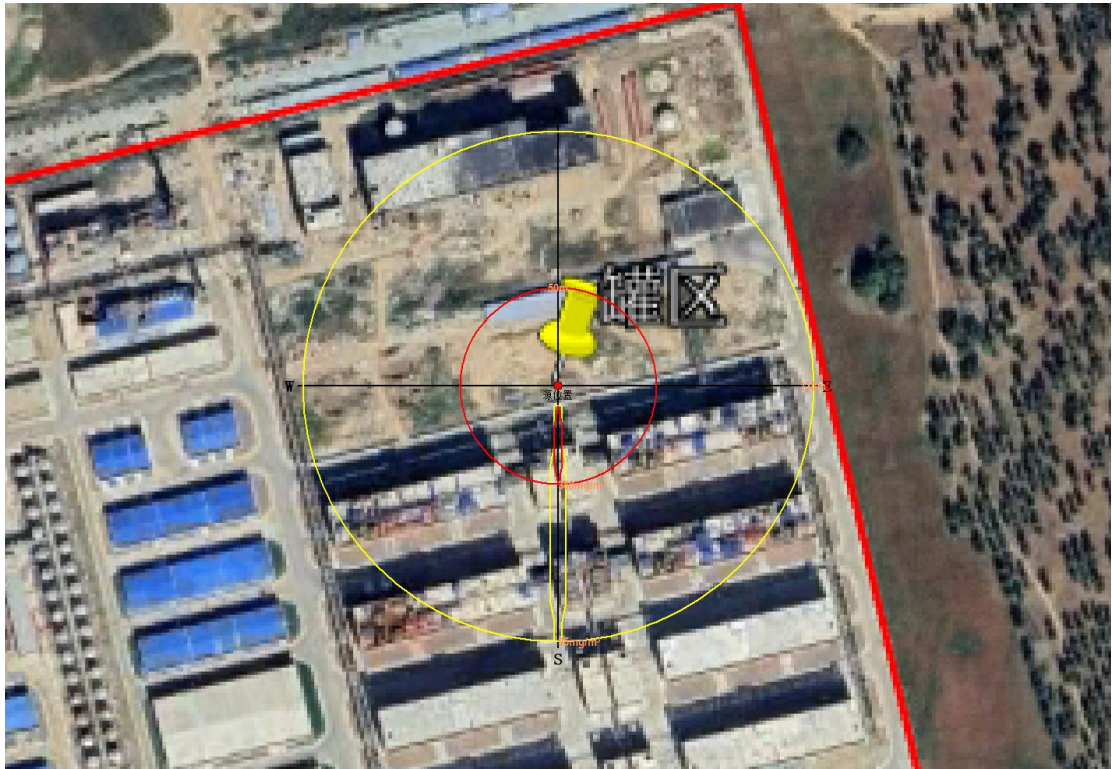
图 8.5-3（2） CO 扩散超过阈值的最大轮廓图（最常见气象条件）
