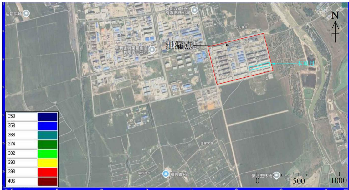
图 6.3-41 渗漏 1000 天污染影响范围（氯化物）
