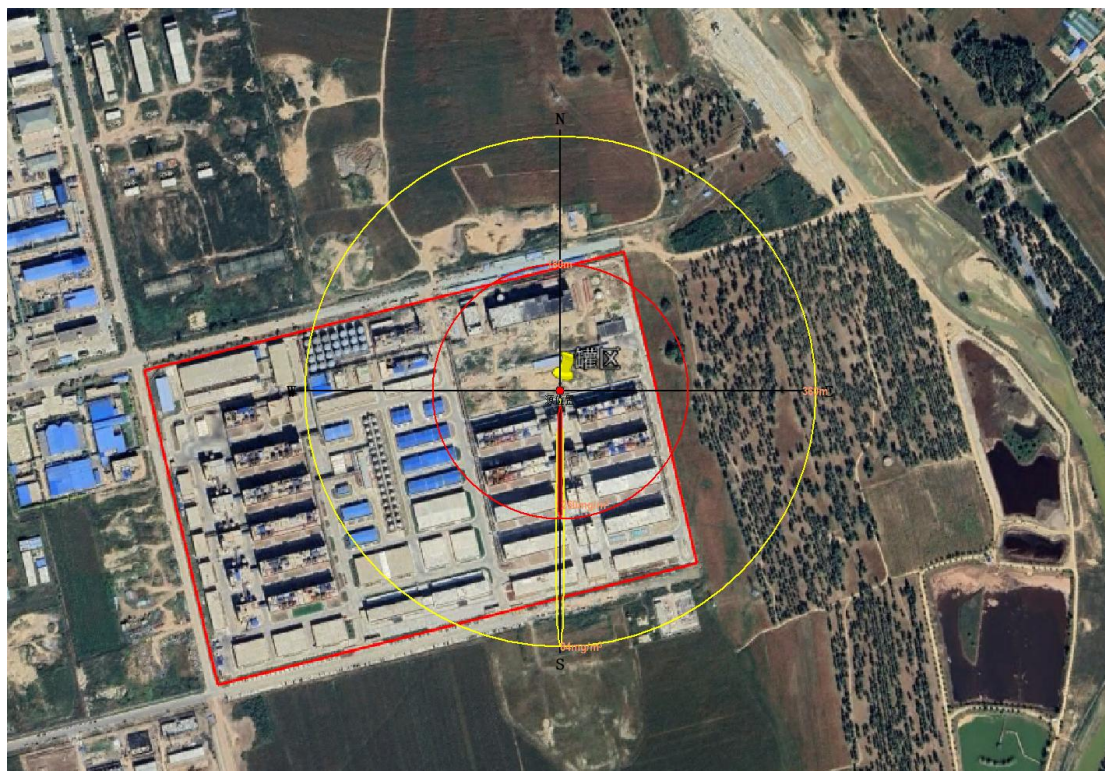
图 8.5-2 (1) 乙腈泄漏扩散超过阈值的最大轮廓图（最不利气象条件）
