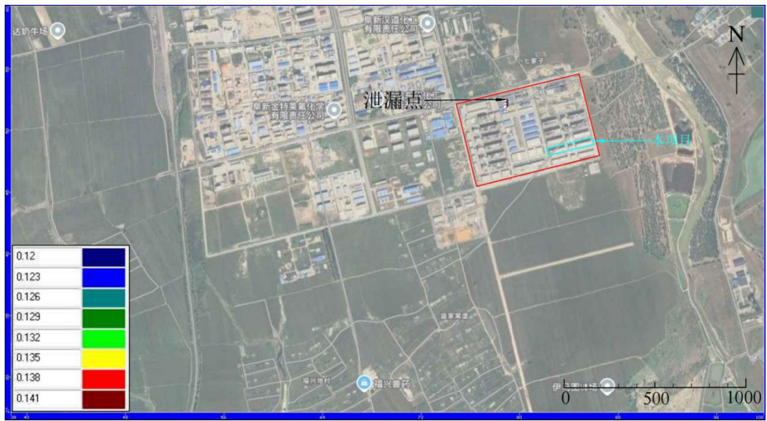
图 6.3-18 渗漏 44 天污染影响范围（苯系物）
