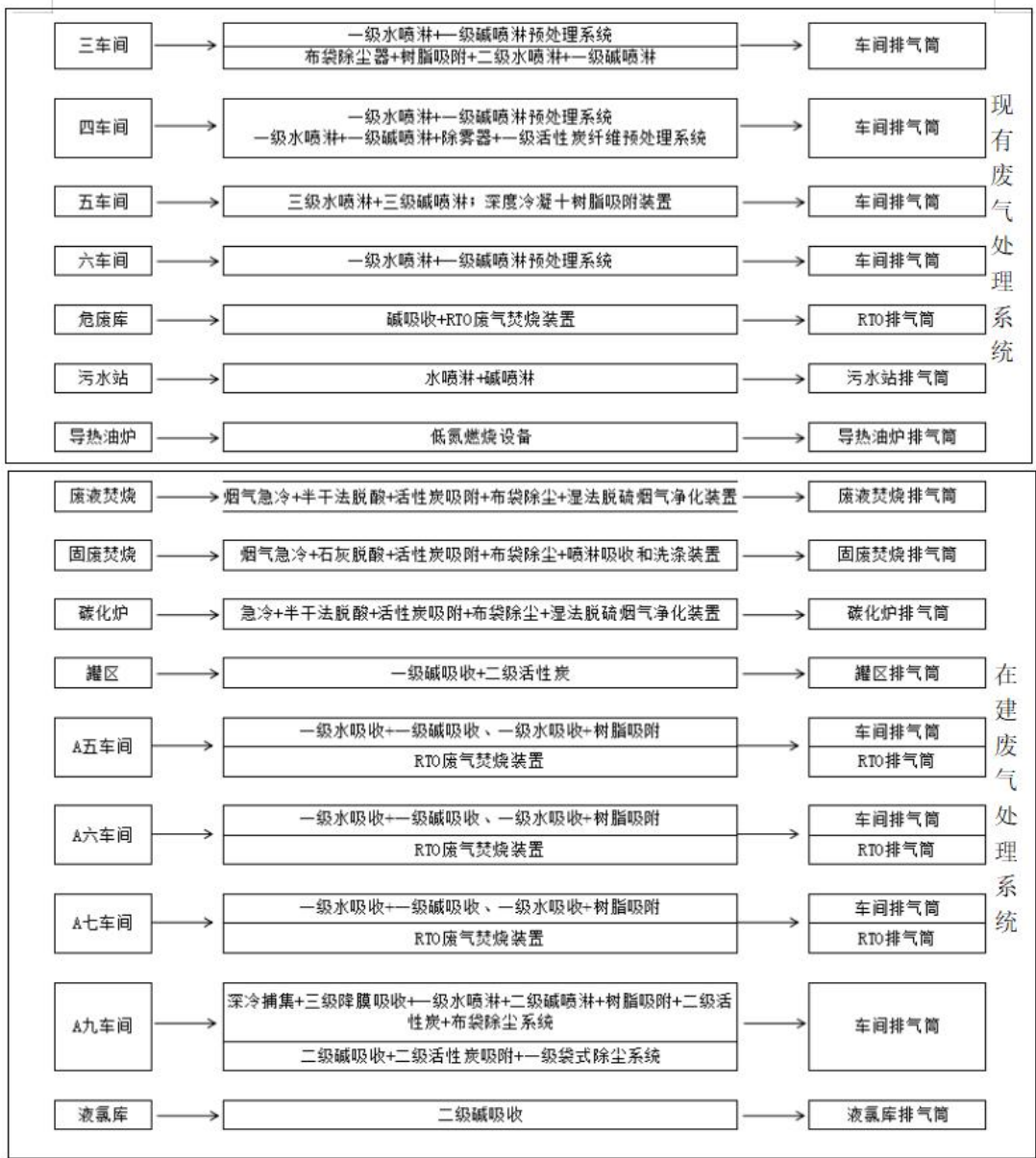
图 3.3-1 现状全厂废气处理系统示意图
