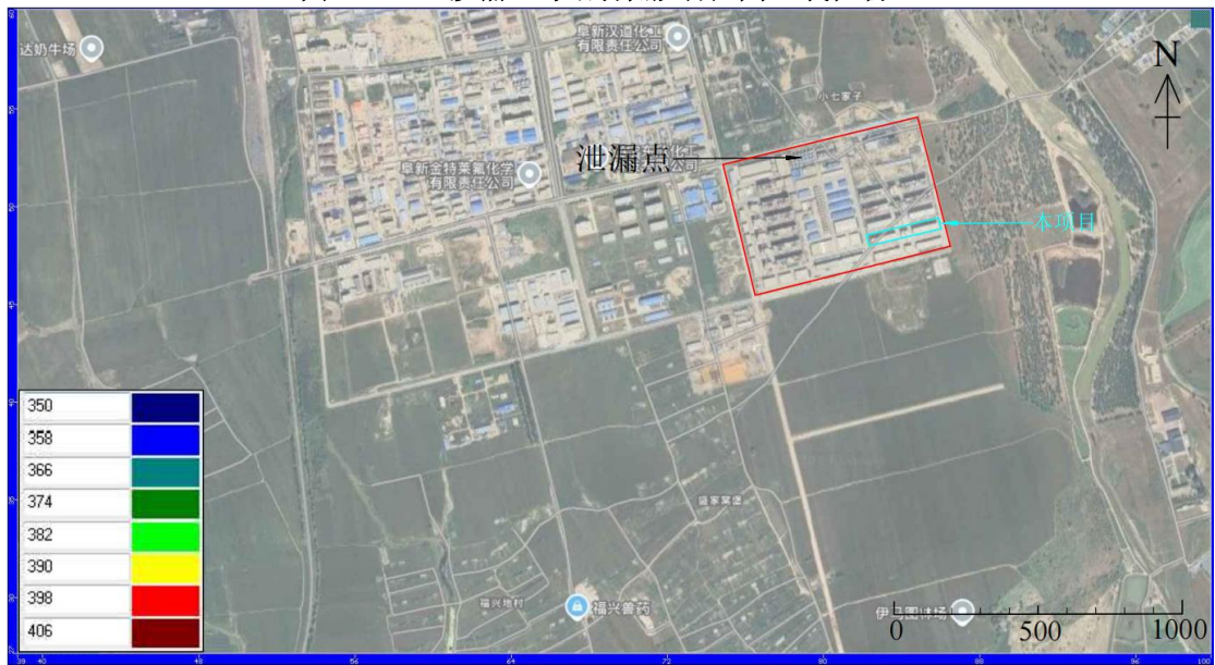
图 6.3-39 渗漏 41 天污染影响范围（氯化物）
