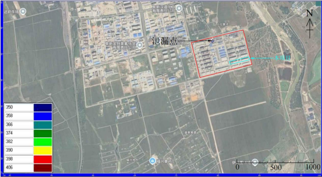
图 6.3-34 渗漏 10 天污染影响范围（氯化物）
