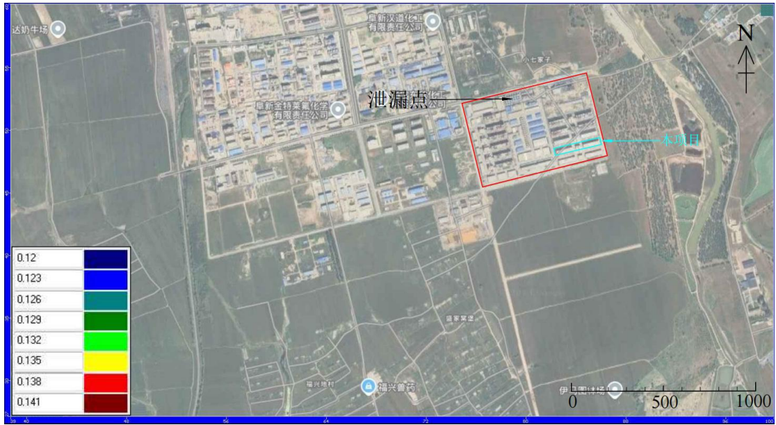
图 6.3-21 渗漏 1000 天污染影响范围（苯系物）
