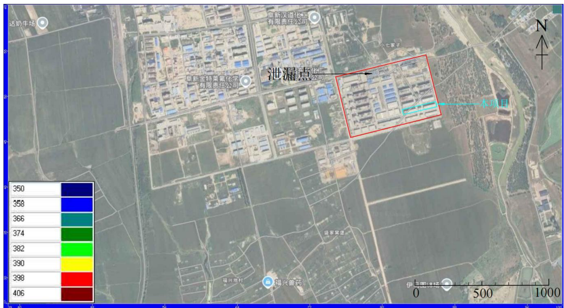
图 6.3-40 渗漏 100 天污染影响范围（氯化物）
