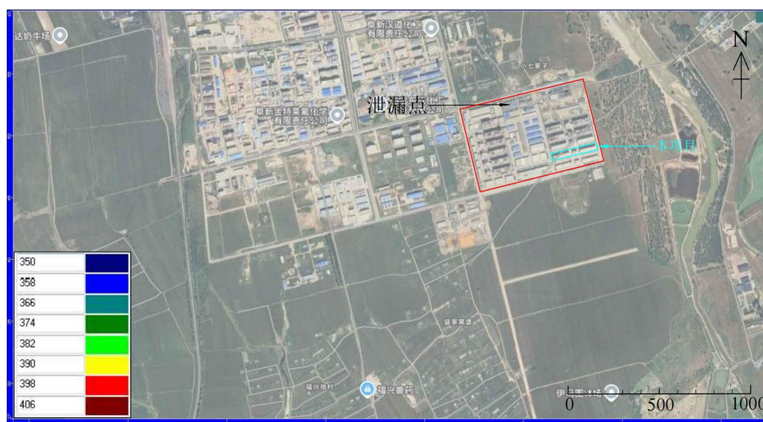
图 6.3-42 渗漏 3650 天污染影响范围（氯化物）
