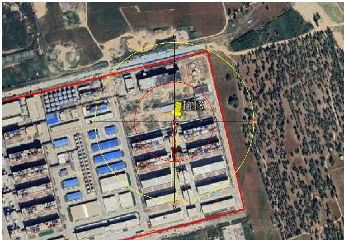
图 8.5-2 (1) 乙腈泄漏扩散超过阈值的最大轮廓图（最不利气象条件）
