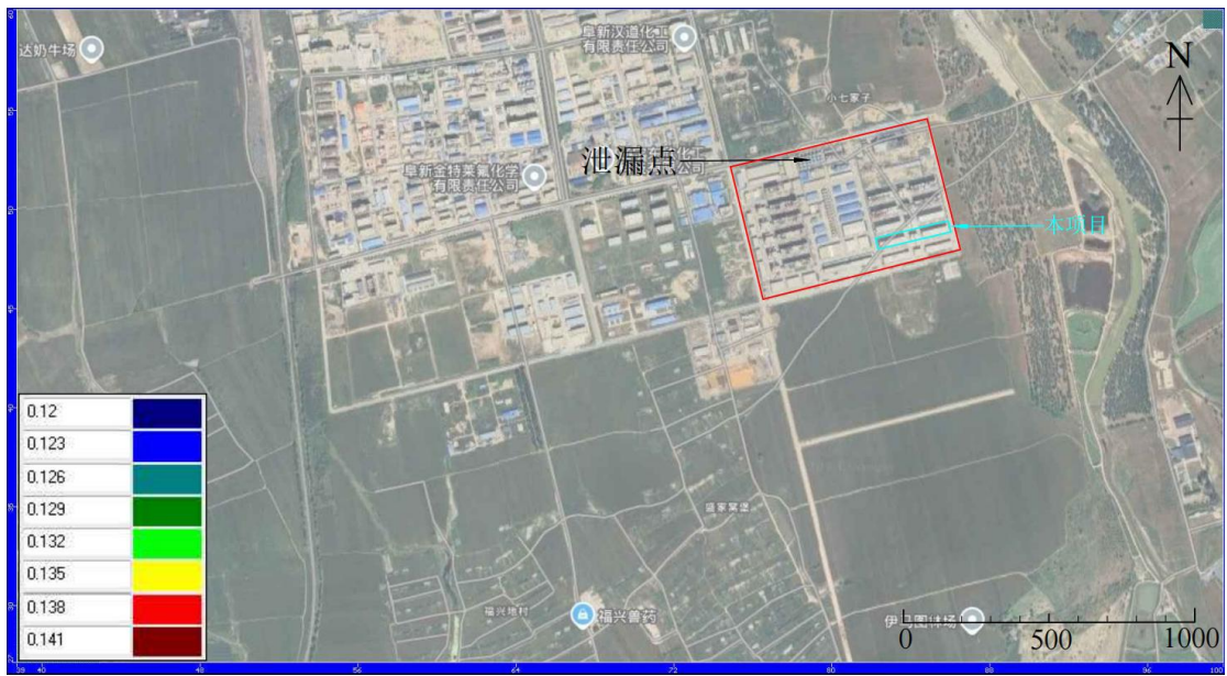
图 6.3-20 渗漏 100 天污染影响范围（苯系物）
