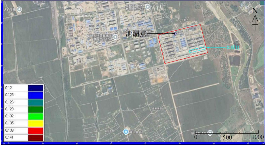
图 6.3-14 渗漏 10 天污染影响范围（苯系物）
