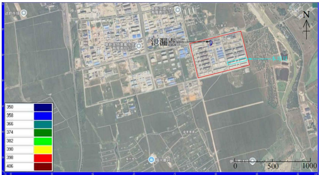
图 6.3-36 渗漏 35 天污染影响范围（氯化物）
