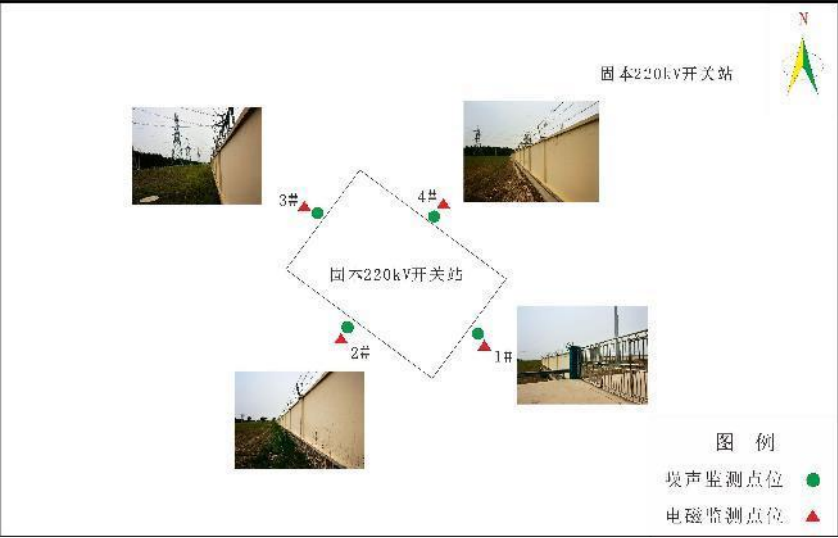
图 3-1 固本 220kV 开关站厂界四周监测布点图
