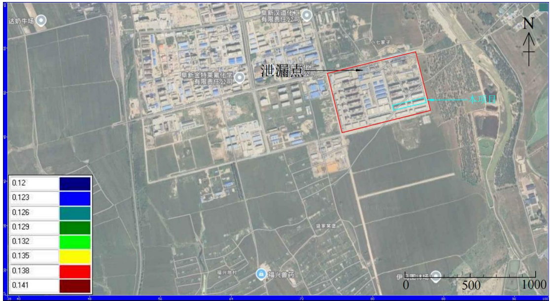
图 6.3-19 渗漏 45 天污染影响范围（苯系物）
