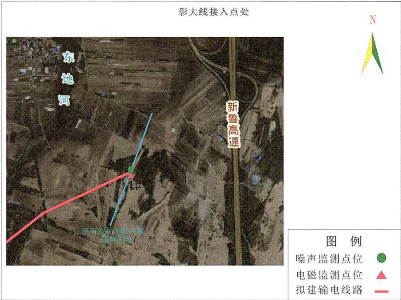
图 1 彰大线接入点处监测布点图
