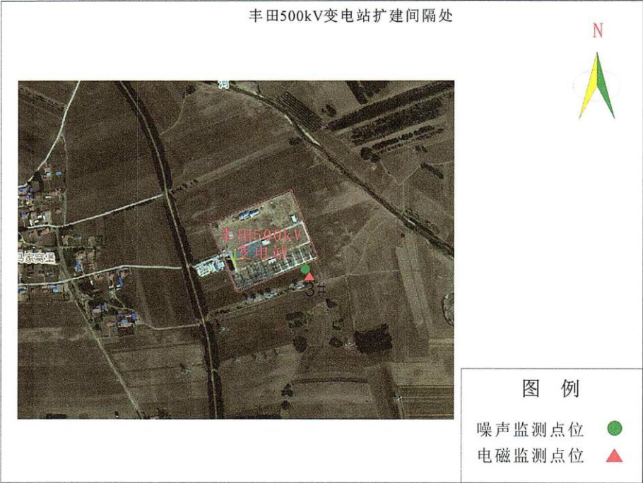
图 3 丰田 500kV 变电站扩建间隔处监测布点图
