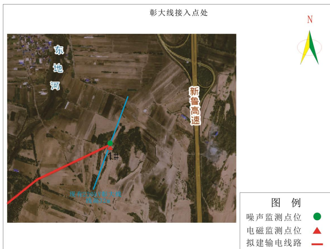
图 1-1 彰大线接入点处检测布点图
