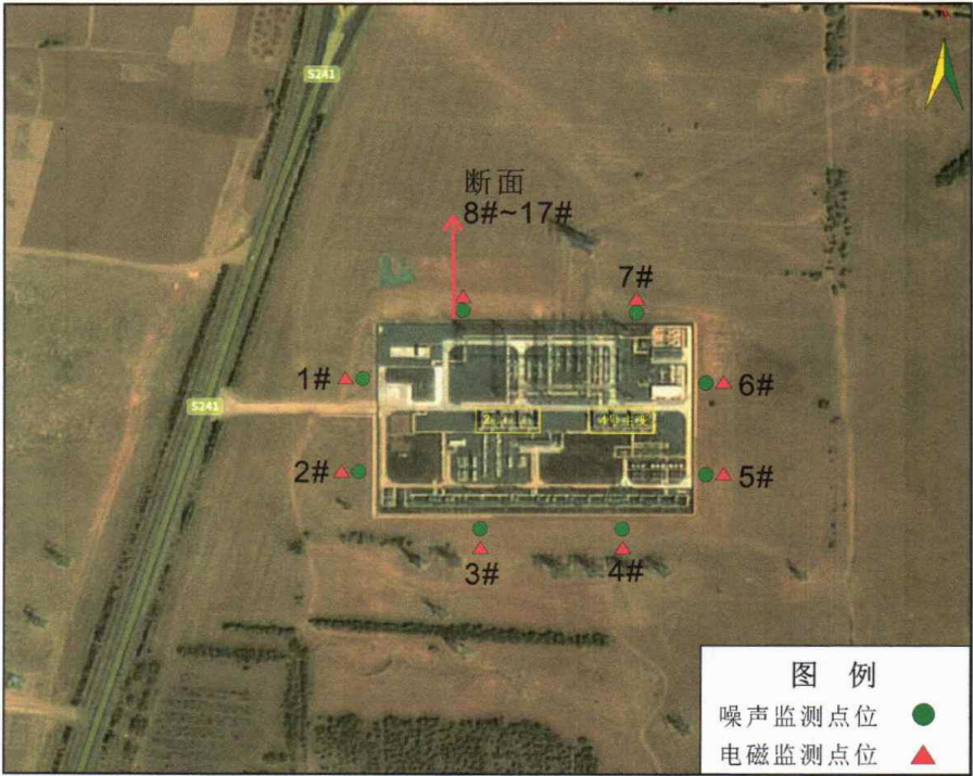
图 1 尚义 500kV 变电站四周检测布点图
