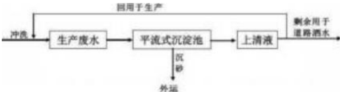
图 7.1-3 养护废水沉淀工艺简图
