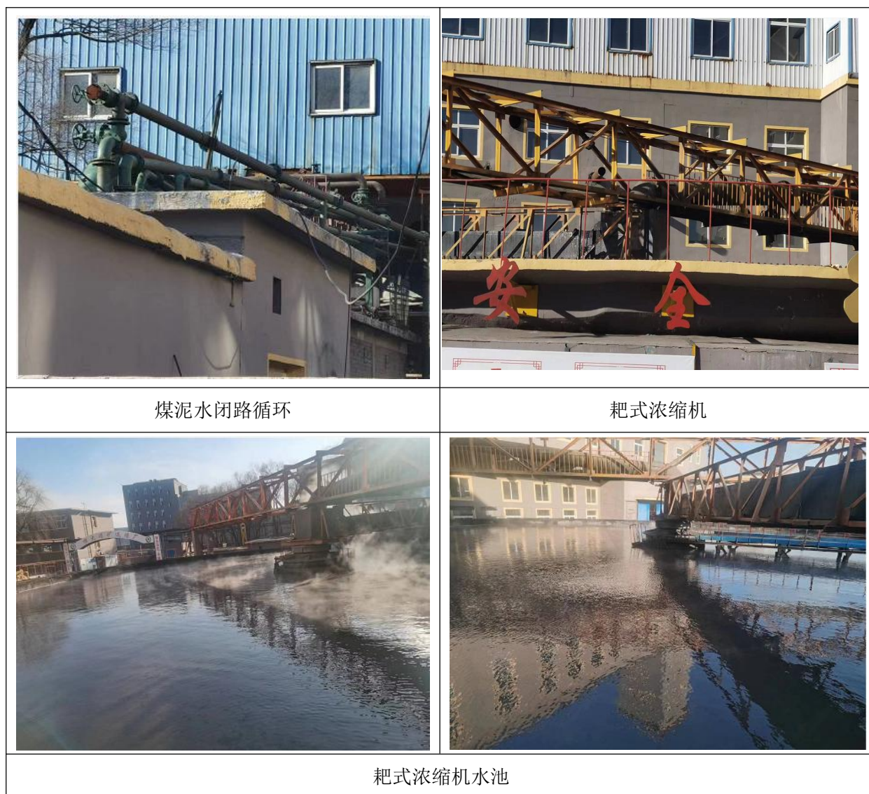
图2.3-4 煤泥水处理现场照片
